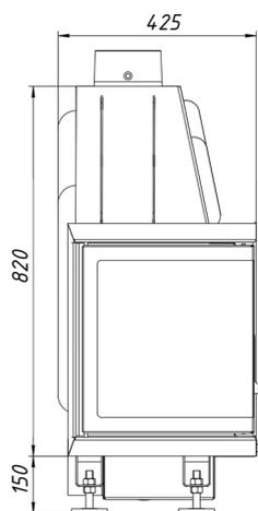
\*Ход регулируемых опор по высоте-40мм
